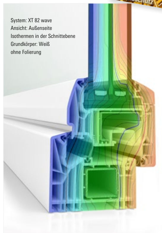
Parameter der dargestellten Isothermen: T_a = -5^\circ\text{C} , T_i bei 20^\circ\text{C} und 50% relative Luftfeuchte, Linie rot: 13^\circ\text{C} , Linie blau: 10^\circ\text{C} , Linie schwarz: 0^\circ\text{C} , Quelle: Schüco International KG
