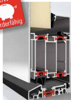
Das Schüco-Profilsystem ADS 75 SimplySmart vereint Wärmedämmung und Stabilität. Die Wärmeleitung wird innerhalb des Aluminiumprofils von Kunststoffisolerstegen durchbrochen (siehe rote Markierungen in der nebenstehenden Abbildung).
